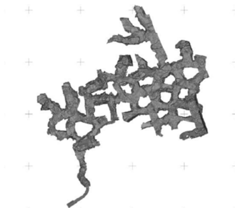
Modèle 3D du réseau souterrain de la carrière de la Maison Blanche à Neuville-Saint-Vaast.
