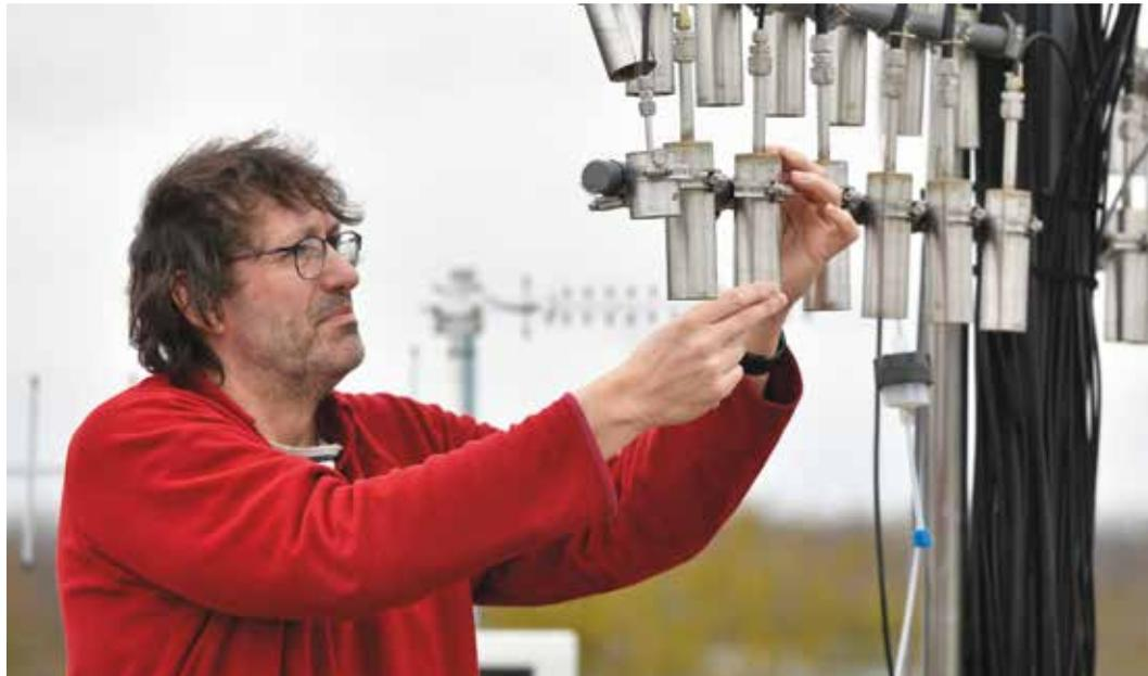
Ingénieur de recherche, Marc Delmotte étudie l'évolution de la composition de l'atmosphère et l'impact des activités humaines, à l'aide de ces lignes de prélèvements d'air. Celles-ci permettent la mesure instrumentale haute précision de la quantité et de la composition des gaz à effet de serre dans l'atmosphère.
